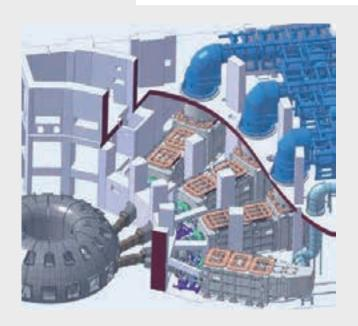
トカマクの運転には9つの支援システムが必要であります。このうち3つのシステムは、プラズマの温度を熱核温度まで上昇させ、トカマクの運転に不可欠なプラズマ電流を制御または維持するために必要です。これらのシステムの1つがビームラインモジュールです。9つの中性粒子ビームライン入射モジュールがあり、プラズマ加熱と電流駆動力の大部分を供給しています。これらの中性粒子ビームラインモジュールはそれぞれ、最大10MVの超高エネルギー原子を生成しています。これらの原子を接線方向のアクセスポートからトーラス(ドーナツ型チャンバー)に入射することで、プラズマ温度を核融合温度まで上昇させ、プラズマ電流の一部を駆動します。ソムニの加速度センサと温度センサは、これらのビームラインモジュールに沿って設置されています。
