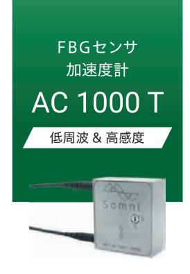
AC 1-ax 1000 T は、フラッグシップ FBG 加速度センサです。高感度で AC 1-ax 1000 T は比類のない感度を備えています。さらに、固有の温度 補正スキームにより、非常に低い周波数と加速度レベルでも正確な読み 取りが可能です。このセンサは、特に大型構造物、橋梁、アーチウェイ、 陸橋、基礎のモニタリングや地盤の揺れの検出に適した超低レベルの低 周波振動の検出を可能にします。
