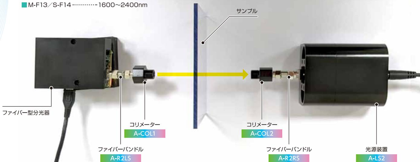
◎液体、透明固体などの透過率測定 (ランプ電力=5W)
