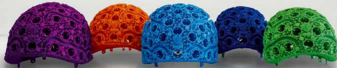
64個のセンサーを頭皮表面にできるだけ近づける独自のヘルメットデザインと、干渉源から発生する不要な磁場を効果的にキャンセルする高度なアレイデザイン
