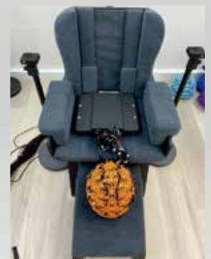
磁気シールドルーム (MSR) 内にて、人間工学に基づいた椅子とヘルメットによりCercaシステムで30分またはそれ以上のセッションで簡単にスキャンすることが可能
