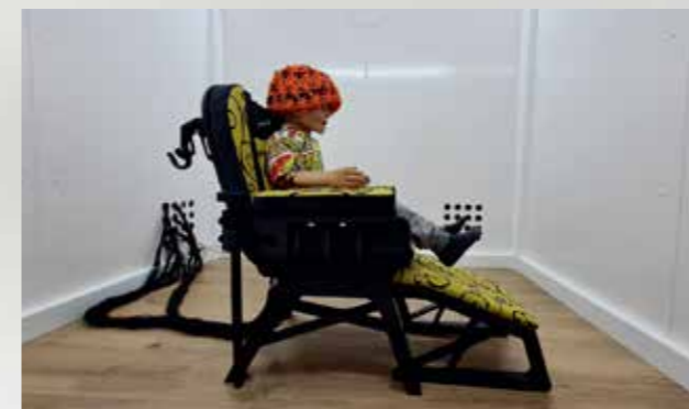
磁気シールドルーム (MSR) 内にて、人間工学に基づいた椅子とヘルメットによりCercaシステムで30分またはそれ以上のセッションで簡単にスキャンすることが可能
