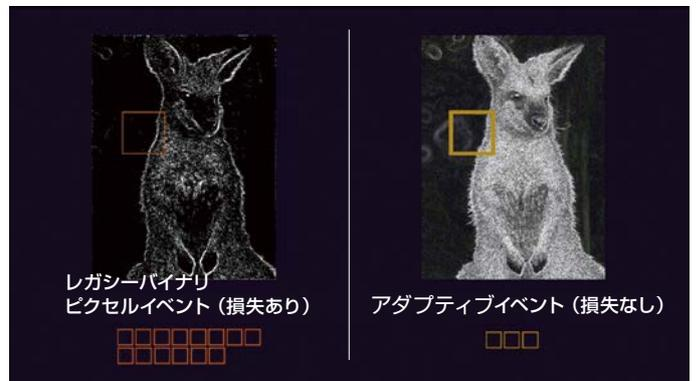
自己適応型スマートピクセルは、ネイティブのハイダイナミックレンジ (HDR) 出力を提供し、特に低照度下でのノイズを最小限に抑えます。
