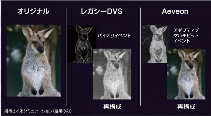
アダプティブマルチビットイベントを用いたロスレス画像を再構成できます。
