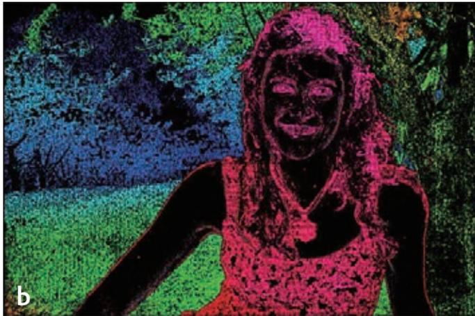
**b** 隣接するマイクロ画像には、シーン中の同じ点が小さな位置ずれとともに撮影されています。その位置ずれ量からその点の3D空間中の位置を計算することができます。このような処理を20,000枚全でのマイクロ画像の画素に対して実施することにより、画像全体に対する3Dデプスマップを生成できます。
