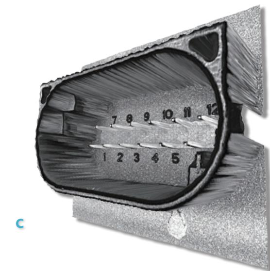
工業製品の生産においては、製品表面を撮影して検査するだけでなく、3D 形状を計測して検査することも重要です。ライトフィールドカメラはどちらにも適用可能です。すなわち、表面を撮影することと 3D 計測の計測が 1 回の撮影で実現できます。ライトフィールドカメラは単一のレンズしか必要としないため、3D 撮影が難しい微小な詳細も記録可能です。
